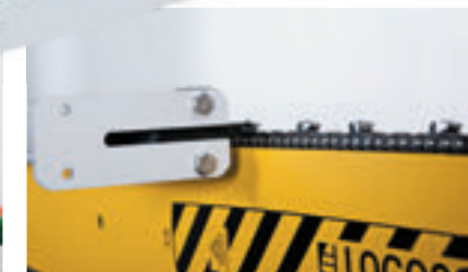
Стабилизатор верхушки шины увеличивает точность.
