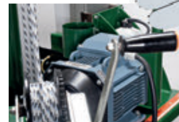
Датчик перегрева двигателя предотвращает перегрев.
