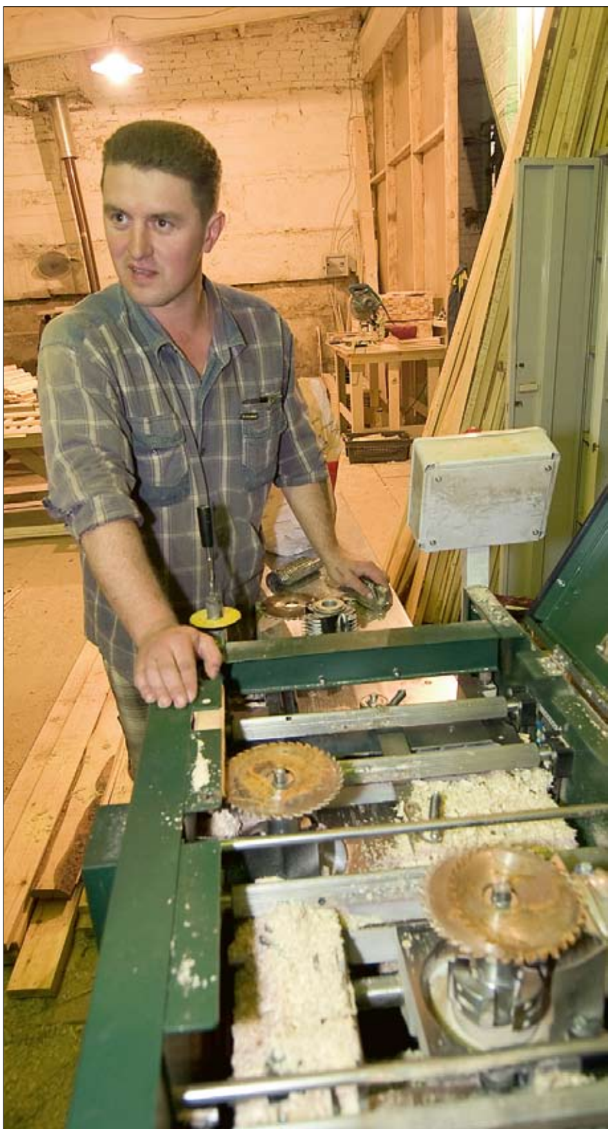
- Вот так станок был переделан на раскроечный, - объясняет Николай Юров. (Это, конечно, не по рекомендации Логосоли).
