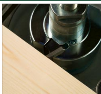
Количество оборотов в 6000 дает гладкую поверхность.
