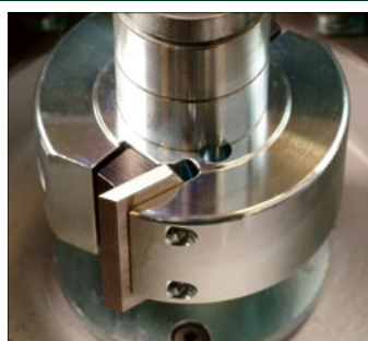
30 мм ось шпинделя. Замена ножей занимает 10-20 мин.
