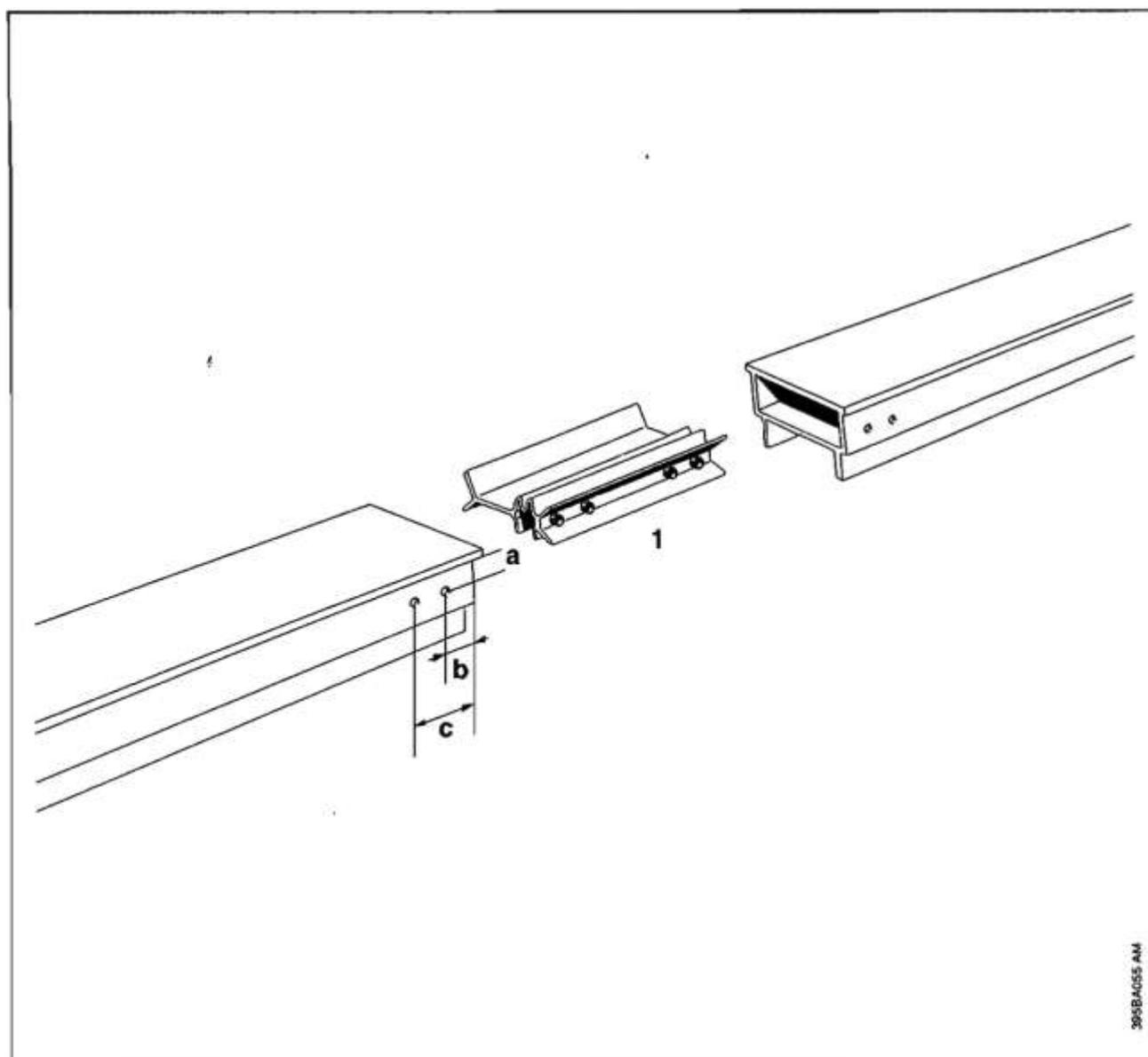
При соединении нескольких комплектов установок в серию, следует просверлить дополнительные отверстия для каждого стыка в одной из линеек.
