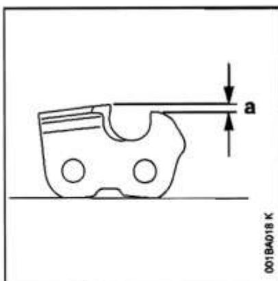
Чтобы обеспечить хорошие режущие свойства цепи для продольного пиления, очень важно сохранить разницу высоты режущих зубьев;  $a=0.65$  мм.
