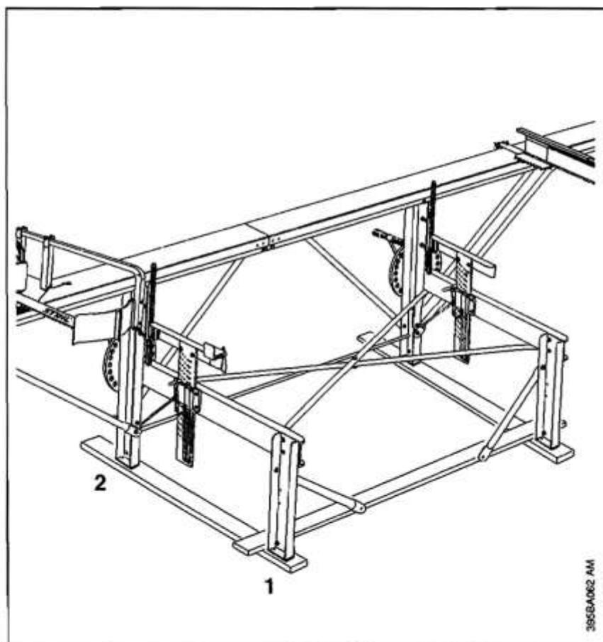
Регулировка взаимной параллельности этажерок
